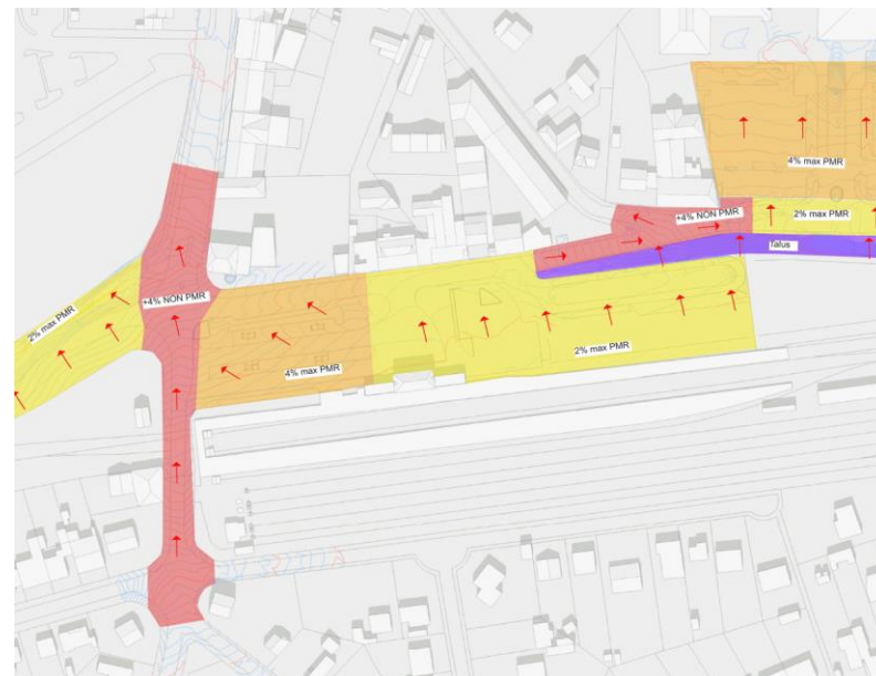
Les pentes autour du pôle gare : de nombreux espaces ne respectant pas les normes PMR
